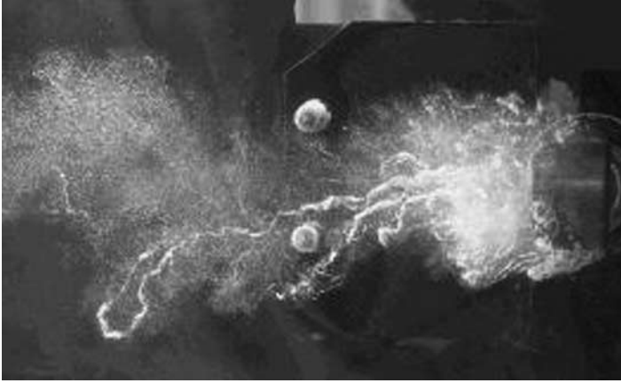
Fig. 1.1. Vortex filaments in a turbulent jet visualized by micro-bubbles. Courtesy of Olivier Cadot, École nationale supérieure de techniques avancées, Paris.
